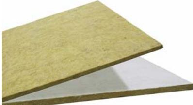
樱花船用薄板 180 (Marine Slab 180) 厚度薄, 平整度好, 能在狭窄区域内满足防火、保温和吸音要求, 扩大使用面积。根据不同的要求, 可以在表面贴玻纤毡等贴面材料。
